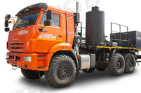
АДПМ 12/150 на пропане
